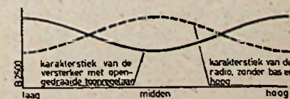
Fig. 2 - Een schetsmatig karakteristiekje van de curven van versterker en radio. Het middengebied is weer aanwezig en geeft aan het totaalbeeld een verrassende warmte en volheid van klank.
