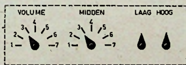
Fig. 6 - Tussen volume en middengebiet bestaat een zeker verband. Cijfers en pijlknoppen voorkomen veel gezocht, nadat zij ingesteld zijn.
